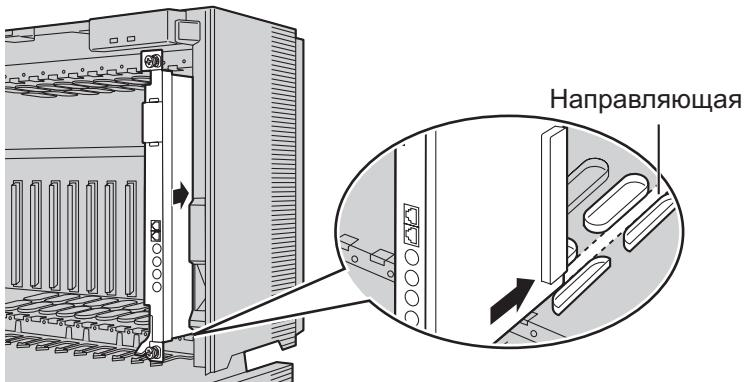
2. Придерживая плату, как показано ниже, поверните фиксатор в направлении, указанном стрелкой, для надежной состыковки разъема платы с разъемом на материнской плате.
