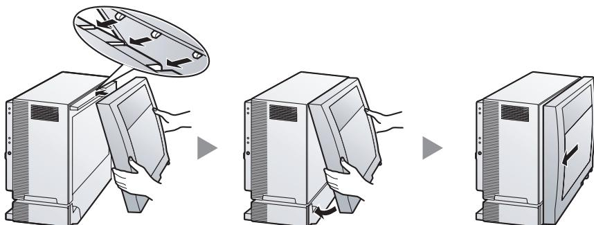
2. Заверните крепежный винт вращением отвертки по часовой стрелке. Установите на место крышку, закрывающую крепежный винт.
