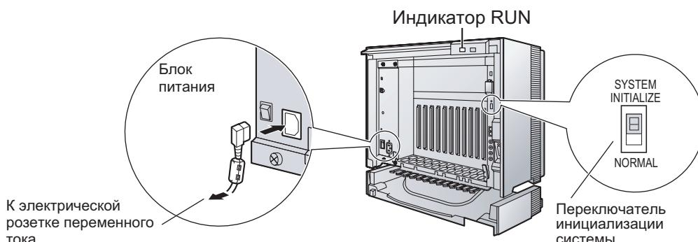
2. Подключите шнур электропитания к УАТС и к электрической розетке переменного тока. Включите УАТС. После этого начнет мигать индикатор RUN.
