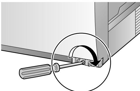
3. Установите на место крышку, закрывая крепежный винт.
