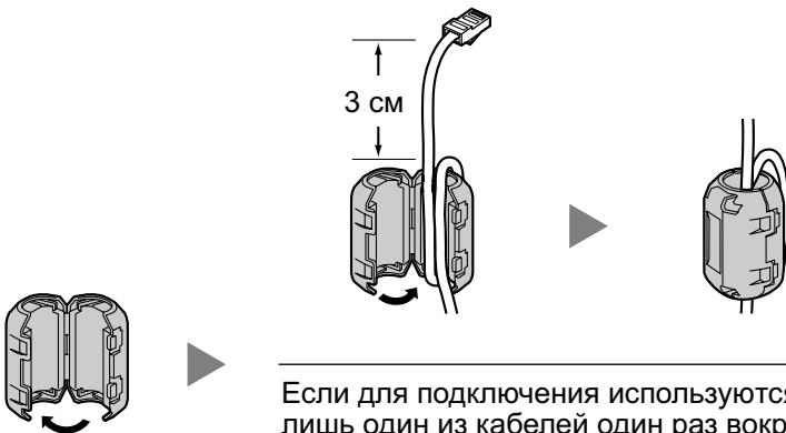
Если для подключения используются 2 кабеля, оберните лишь один из кабелей один раз вокруг ферритового сердечника. Затем просто пропустите другой кабель через ферритовый сердечник.
