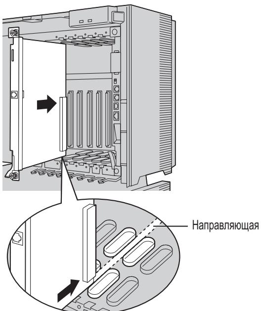
2. Придерживая плату, как показано ниже, поверните фиксатор в направлении, указанном стрелкой, для надежнойстыковки разъема платы с разъемом на материнской плате.
