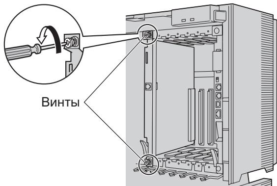
2. Поверните фиксатор в направлении, показанном на рисунке стрелкой, для разъединения системной платы и материнской платы. Извлеките плату из блока.
