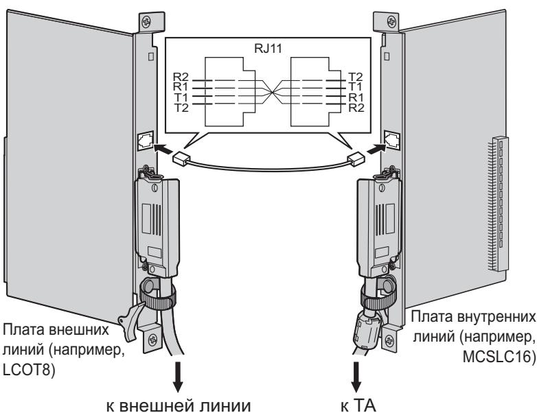
**Дополнительные детали и компоненты, поставляемые пользователем****Дополнительные детали (в комплекте поставки):** нет**Компоненты, поставляемые пользователем (не входят в комплект поставки):** кабели с разъемом типа RJ11**Назначение контактов разъема RJ11 для платы аналоговых внешних линий****Порты PFT 1 и 2**
