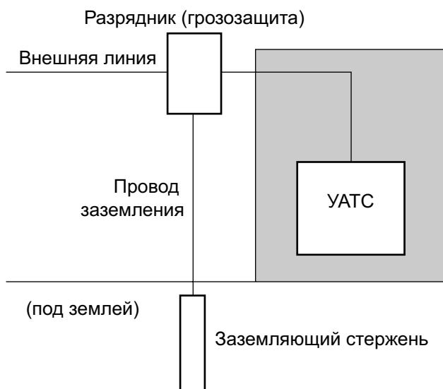
1. Подключите заземляющий стержень к разряднику проводом заземления, имеющим сечение по крайней мере 1,3 мм<sup>2</sup>.
