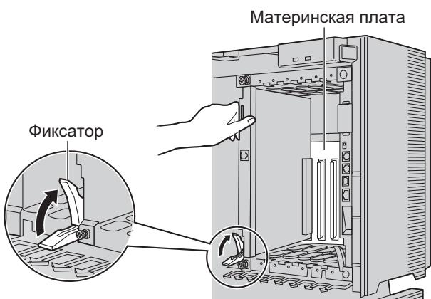
3. Заверните 2 винта (по часовой стрелке) для закрепления платы.
