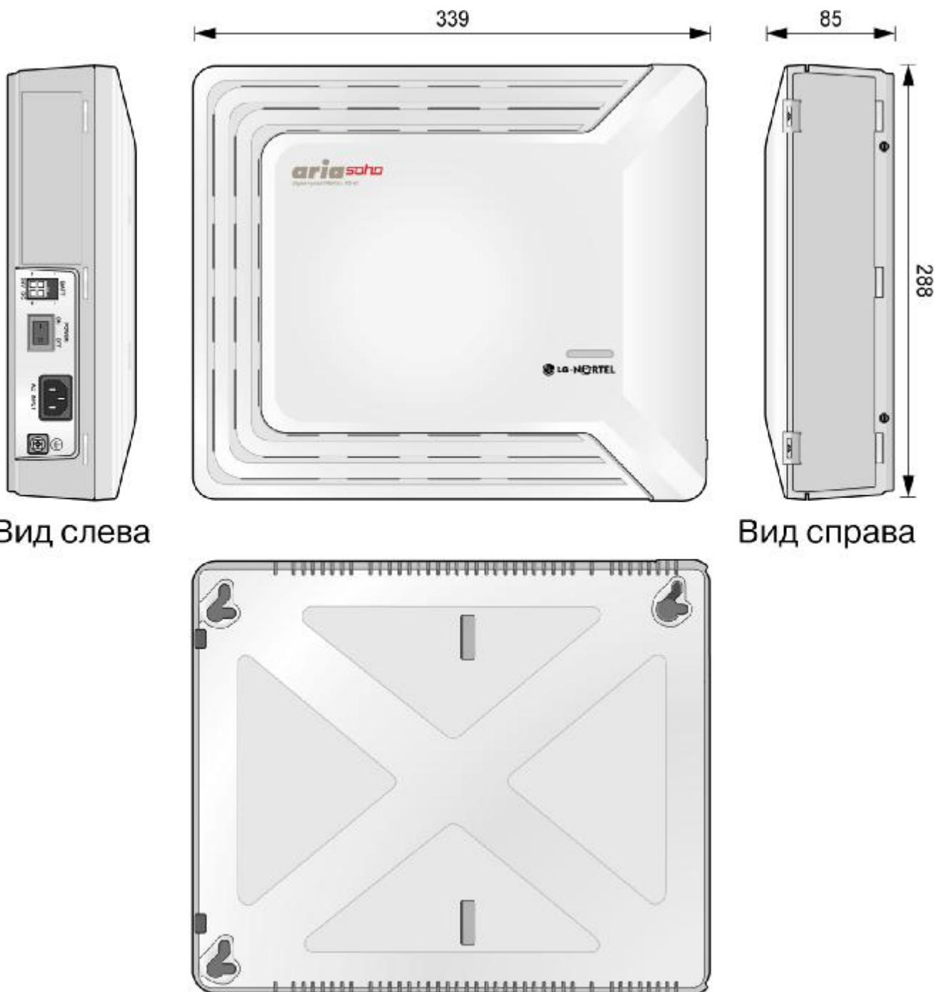
Рис. 3.2.2 Внешний вид и размеры системного блока
