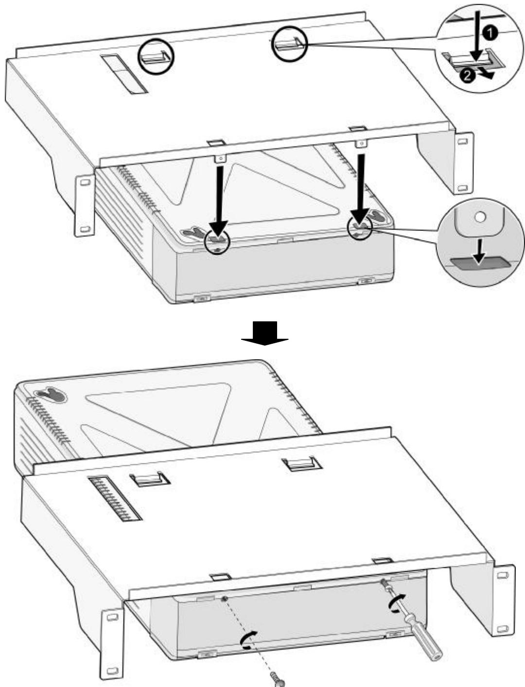
Рис. 3.2.7.26 Установка стоечного крепления
