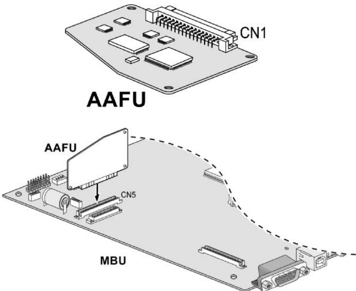
Рис. 4.5.2 Плата автоматического оператора AAFU
