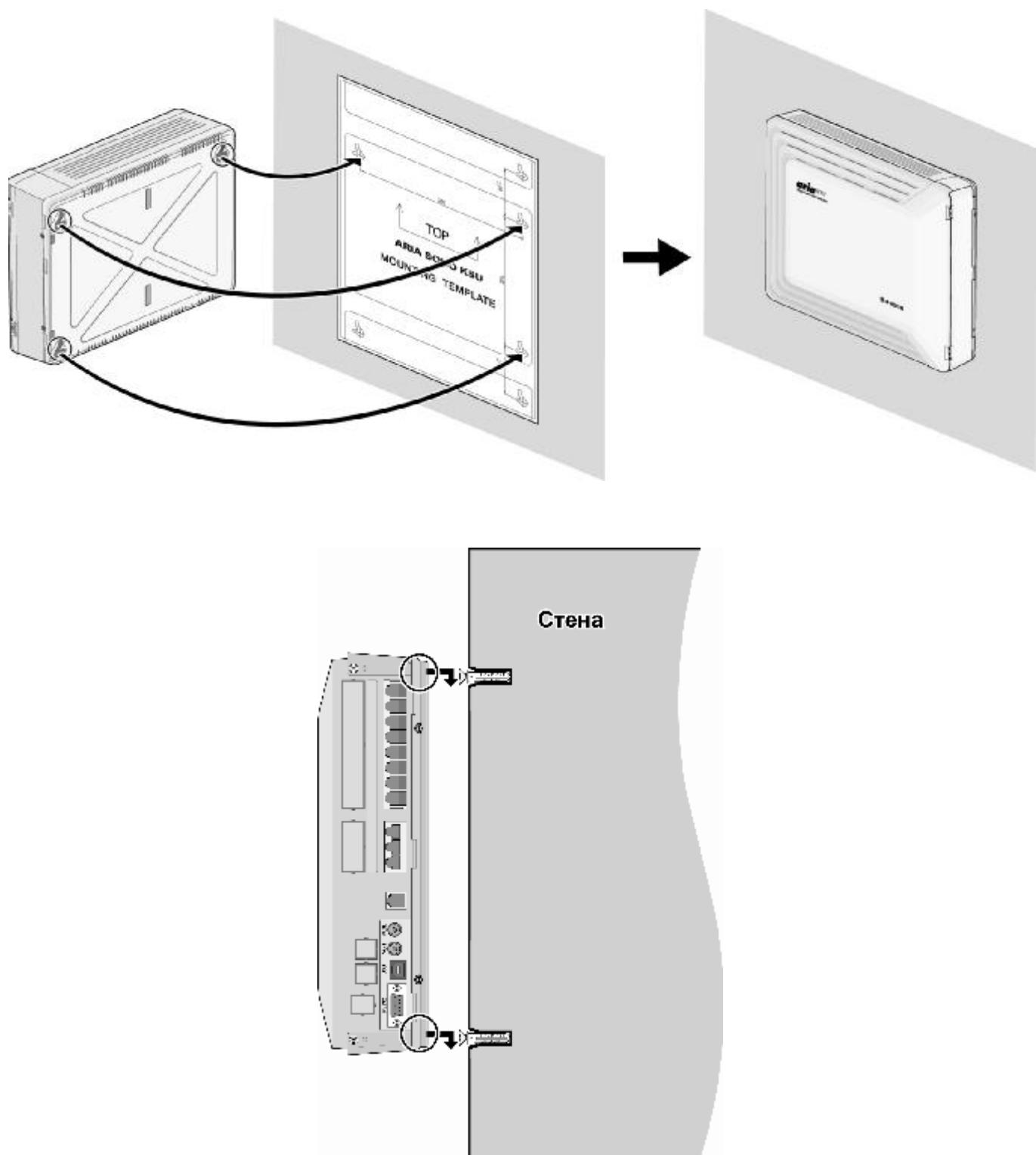
Рис. 3.2.7.16 Настенный монтаж системного блока
