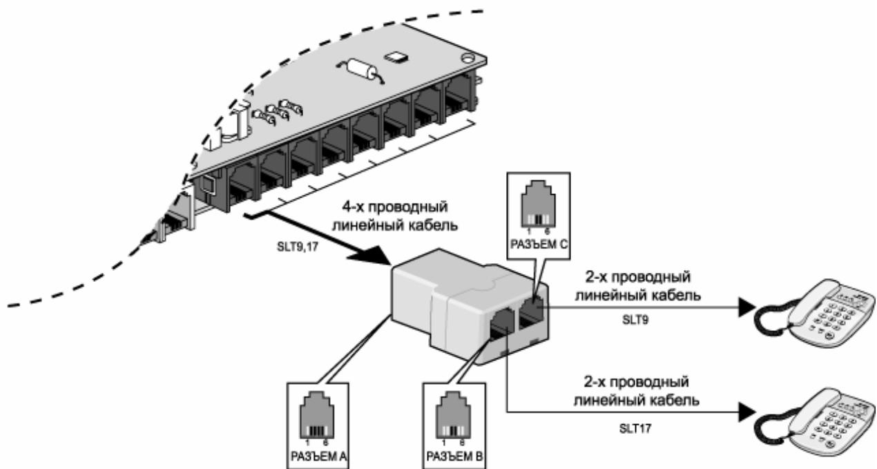
Рис. 4.4.2.2 Терминальный переходник
