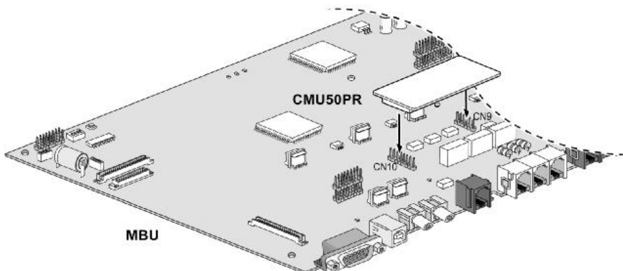
Рис. 4.5.6 Модуль определения импульсов тарификации CMU50PR
