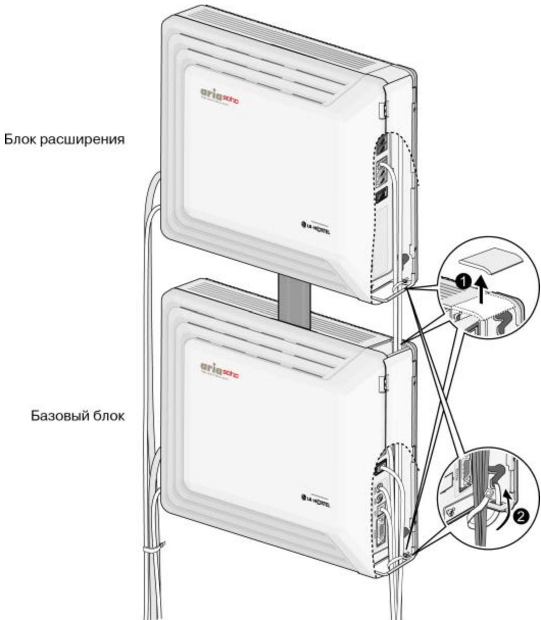
Рис. 5.2.1 Прокладка кабелей при настенном монтаже
