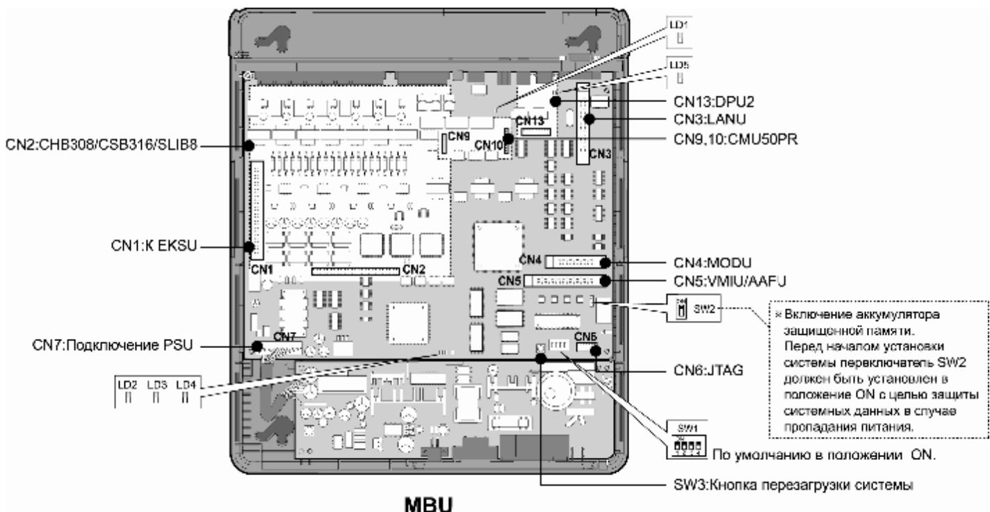
Рис. 4.2а Материнская плата базового блока (MBU)
