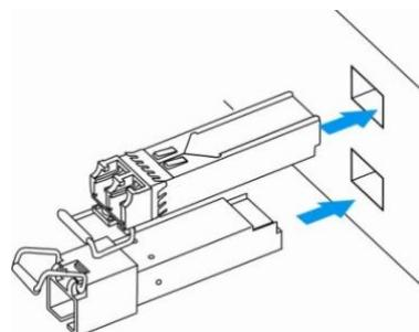
Рисунок 27 – Установка SFP-трансиверов
