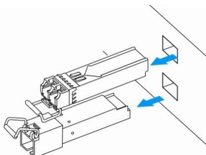
Рисунок 30 – Извлечение SFP-трансиверов
