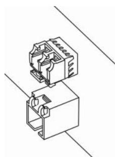
Рисунок 28 – Установленные SFP-трансиверы
