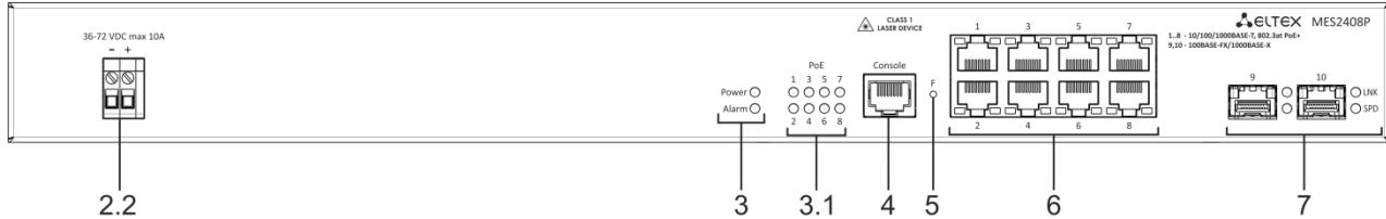
Рисунок 9 – Передняя панель MES2408P DC
