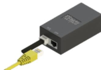
7. Подключите PoE-инжектор к розетке 220 В с помощью сетевого шнура.
