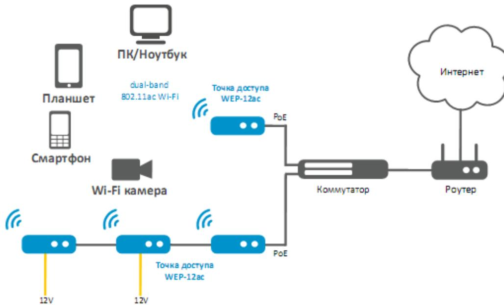
Рисунок 1 – Функциональная схема использования WEP-12ac
